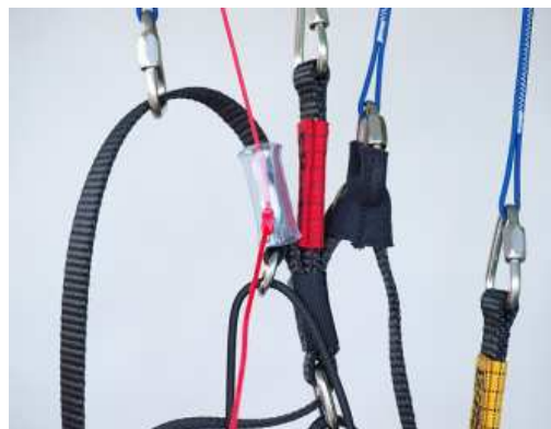
Figure 5 : A côté du TEA il y a une boucle supplémentaire qui peut être utilisée pour contrer l'effet de couple. Dans ce cas, il n'y a pas d'ajustement possible, il y a seulement 2 positions. Alors qu'au niveau du TEA, le nœud est réglable.
