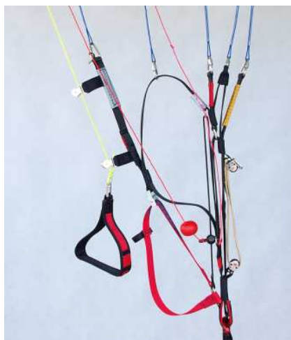
Figure 2 : Point d'attache haut (la ligne de freins passe à travers 2 poulies. Boule ALC en position basse).
