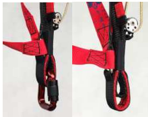
Figure 5 : A côté du TEA il y a une boucle supplémentaire qui peut être utilisée pour contrer l'effet de couple. Dans ce cas, il n'y a pas d'ajustement possible, il y a seulement 2 positions. Alors qu'au niveau du TEA, le nœud est réglable.
